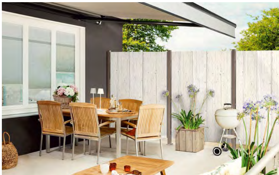
Die 6 mm-Aluverbundplatten in der Duplex-Variante im hellen Dekor Altholz-Creme dienen hier als Füllung für Sichtschutz und Balkonbrüstung, harmonisch kombiniert zur Fassade in der Unifarbe Dunkelgrau
