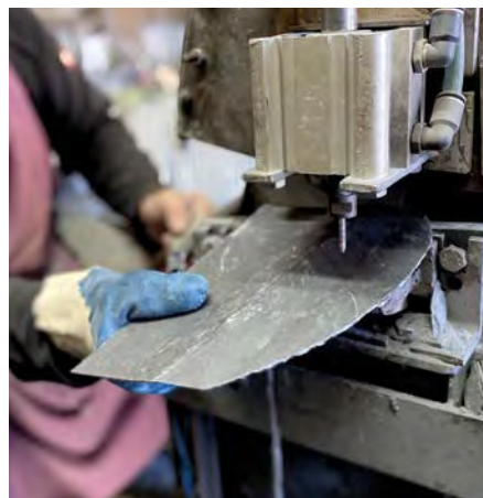
Traditionelle Frei-Hand-Zurichtung in der Altdeutschen Deckung
