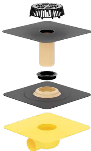
Doppelt dicht auf allen Ebenen: Zwei individuell wählbare Wunschanschlussmanschetten schließen den SitaSani® Disc und das Aufstockelement rückstausicher an die jeweilige Abdichtung an. Bild: Sita Bauelemente GmbH
